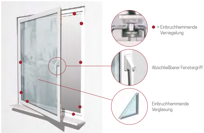
^ Fenster der Widerstandsklasse [RC] 2 nach DIN EN 1627
